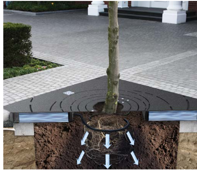
Unterflurbaumrost mit integriertem Bewässerungssystem (Bewässerungssystem SIPA, Fa. Humberg)
